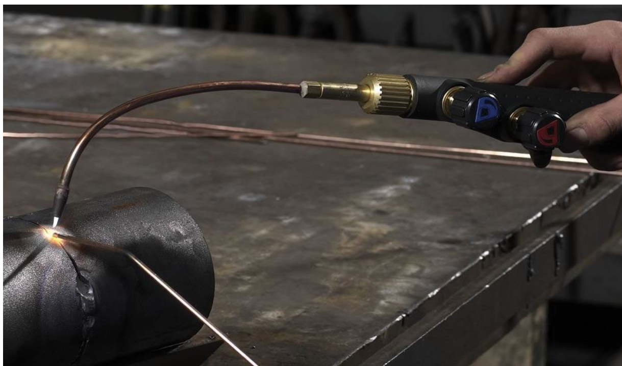
Vymeniteľná FLEXI dýza nástavca s kovaným otvorom dýzy.
