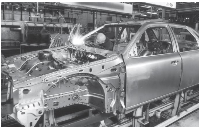
Obrázok 1 MAG zváranie automobilovej karosérie
