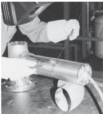
Obrázok 6 Zváranie CrNi ocele metódou TIG so súčasnou ochranou koreňa zvaru
