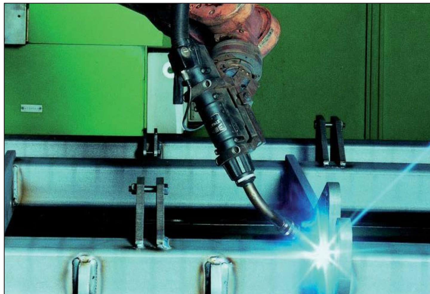
Robotizované MAG zvarovanie
