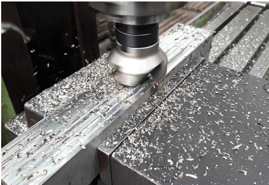
Obr. 1. Ze svařenců byly obrobena vzorky, které byly následně podrobeny tahové zkoušce. (Zdroj: Messer Technogas)
