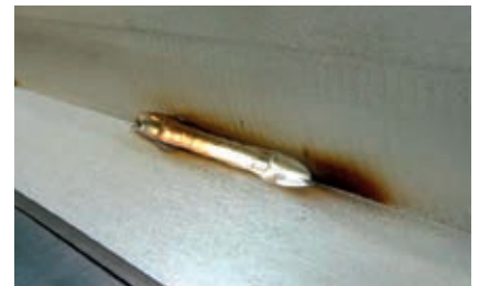
Inoxline He3H1 – tento plyn přináší výraznou redukci vneseného tepla a tím i snížení deformace svařovaných dílců.
