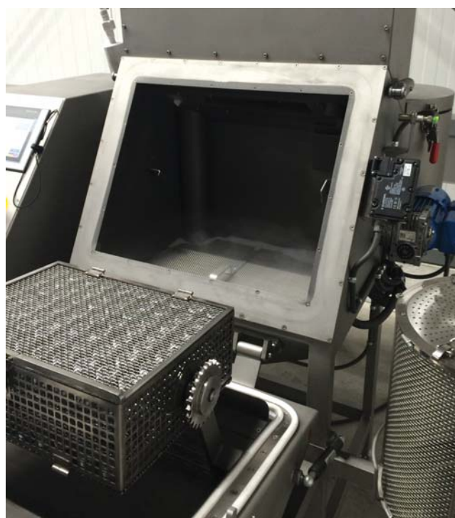
Tryskací komora nejmenšího typu zařízení včetně košíku (415 x 310 x 130 mm) a bubnu (vpravo dole, objem 36 l vhodný pro cca 12 l odlitků) pro umístění dílů
