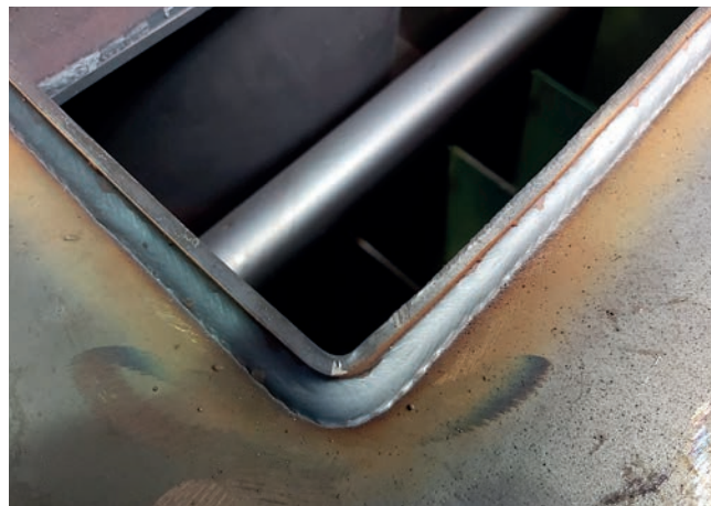
Obr. 4 – Ferroline C6X1 povrch svaru
