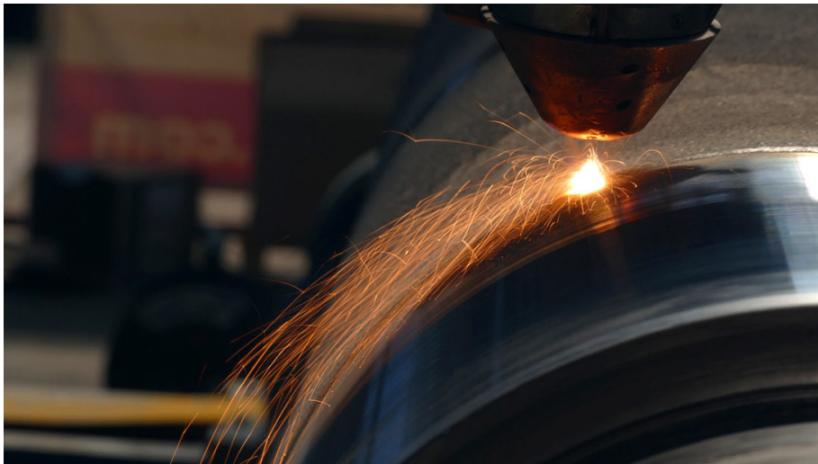
Obr. 1. Laserové navařování s podáváním prášku. (Zdroj: Matex PM)
