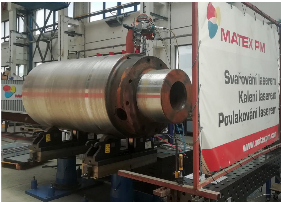
Obr. 2. Laserové navařování hřídele. (Zdroj: Matex PM)
