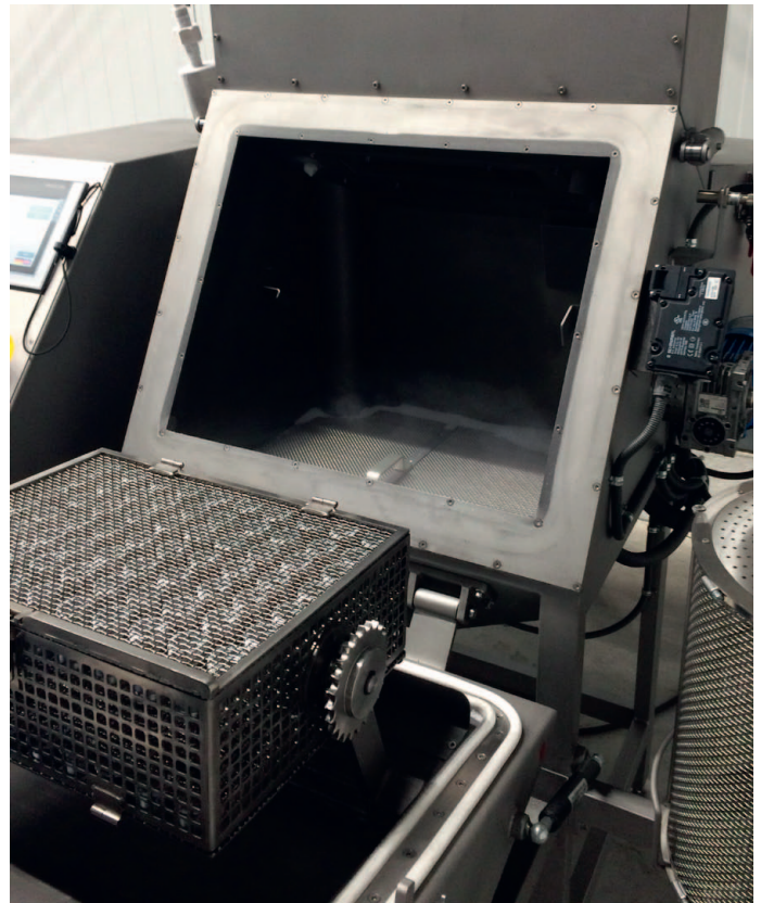
Tryskací komora zařízení s uchyceným košíkem, ve kterém jsou umístěny plastové díly
