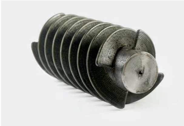
Šnek dopravníku vyrobený metodou tisku LMD
