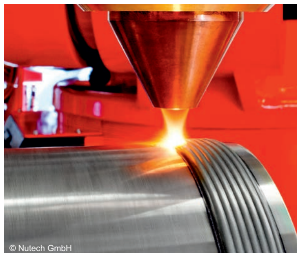
Laserové navařování práškových kovů
