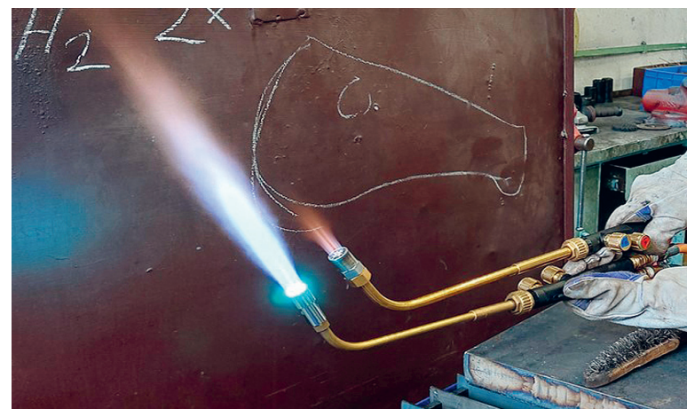
Obr. 2: Porovnání vodíkového (vpravo) a acetylenového plamene
