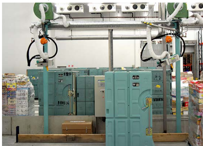
Obr. 2: Společnost Messer vyvinula spolu s Olivo Cold Logistics systém Siber pro zachování teplot během transportu potravin.
