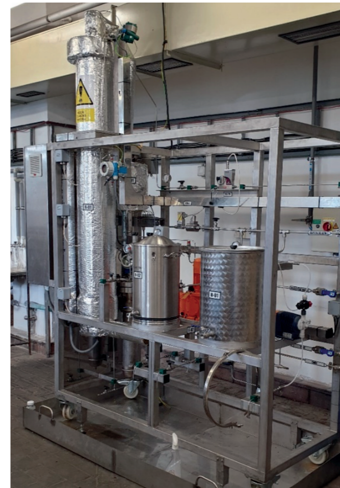
Obr. 2: Pilotní jednotka technologie katalytické mokré oxidace
