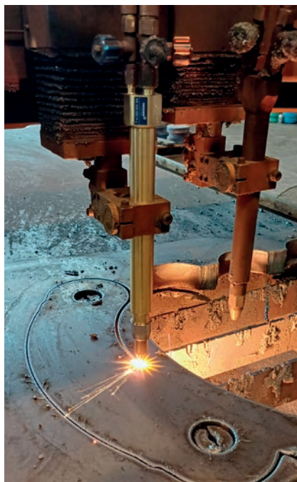
Obr. 3 – Strojní hořák MESSER MS 932 H.
