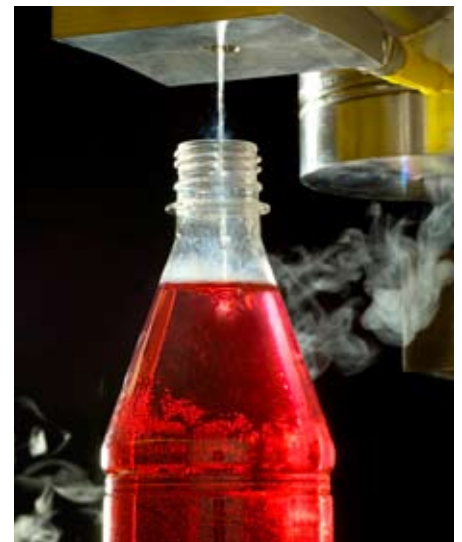
Schützt und stabilisiert: flüssiger Stickstoff beim Befüllen von Flaschen
