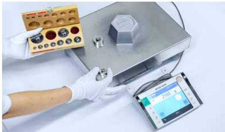
*Etalonnage des balances utilisées*
