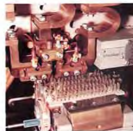
Widerstandsschweißen von qualitativ hochwertigen, elektrischen Teilen, z. B. Programmschalter für Waschmaschinen
