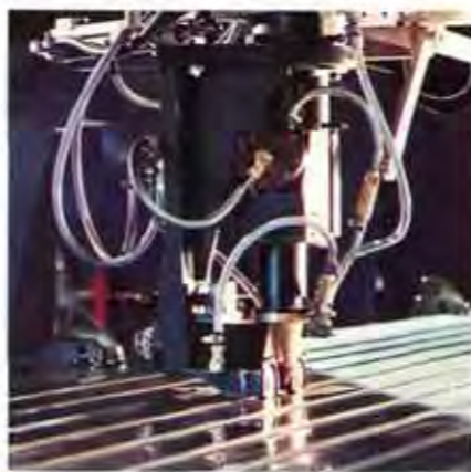
Wärmetauscher für die Lebensmittelindustrie werden mit dem Laserstrahl verzugsfrei geschweißt; die Nacharbeit entfällt
