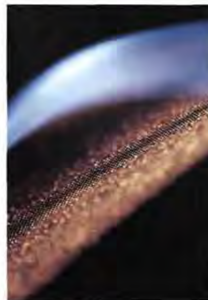
Sichtbar gemacht: mikroskopisch kleine Löcher gebohrt mit dem Elektronenstrahl.
