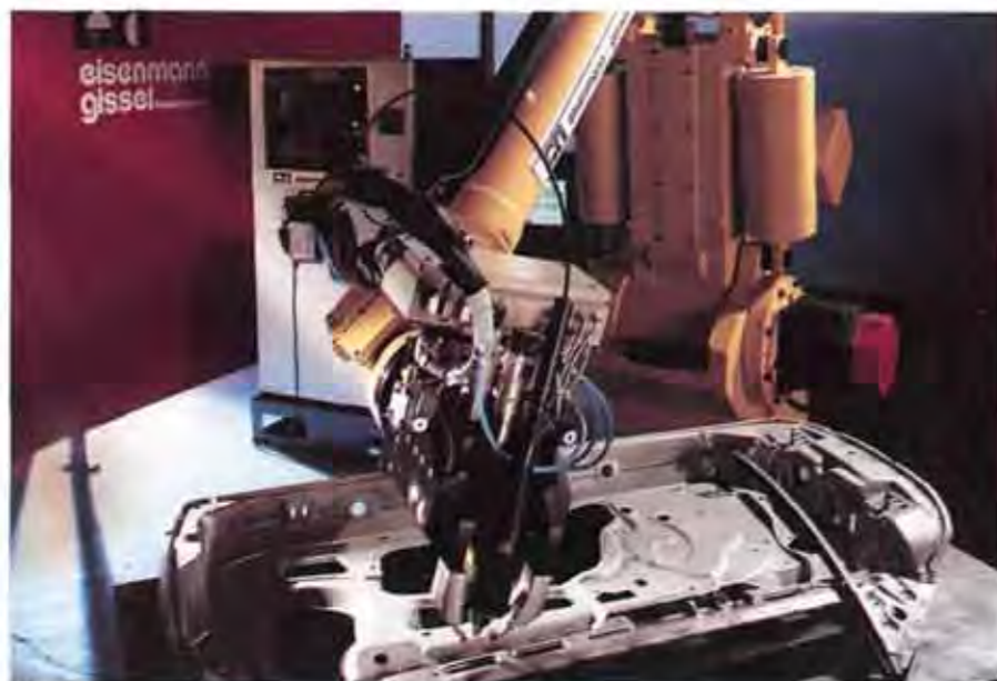
Technische Vorteile beim Schweißen von Karosserieteilen verspricht die neue Kombination aus Roboter, Festkörperlaser und Bewegungseinheit
