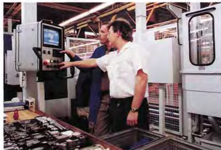
Wirtschaftliche Lösung für den Schiffbau durch CNC-gesteuertes Schneiden, Sandstrahlen und Pulvermarkieren auf einer Anlage
