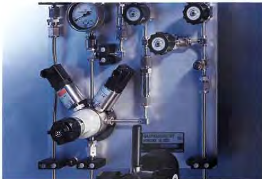
Neue Reinstgasversorgungssysteme ermöglichen den kontaminationsfreien Gasetransfer bis zum Einsatzort
