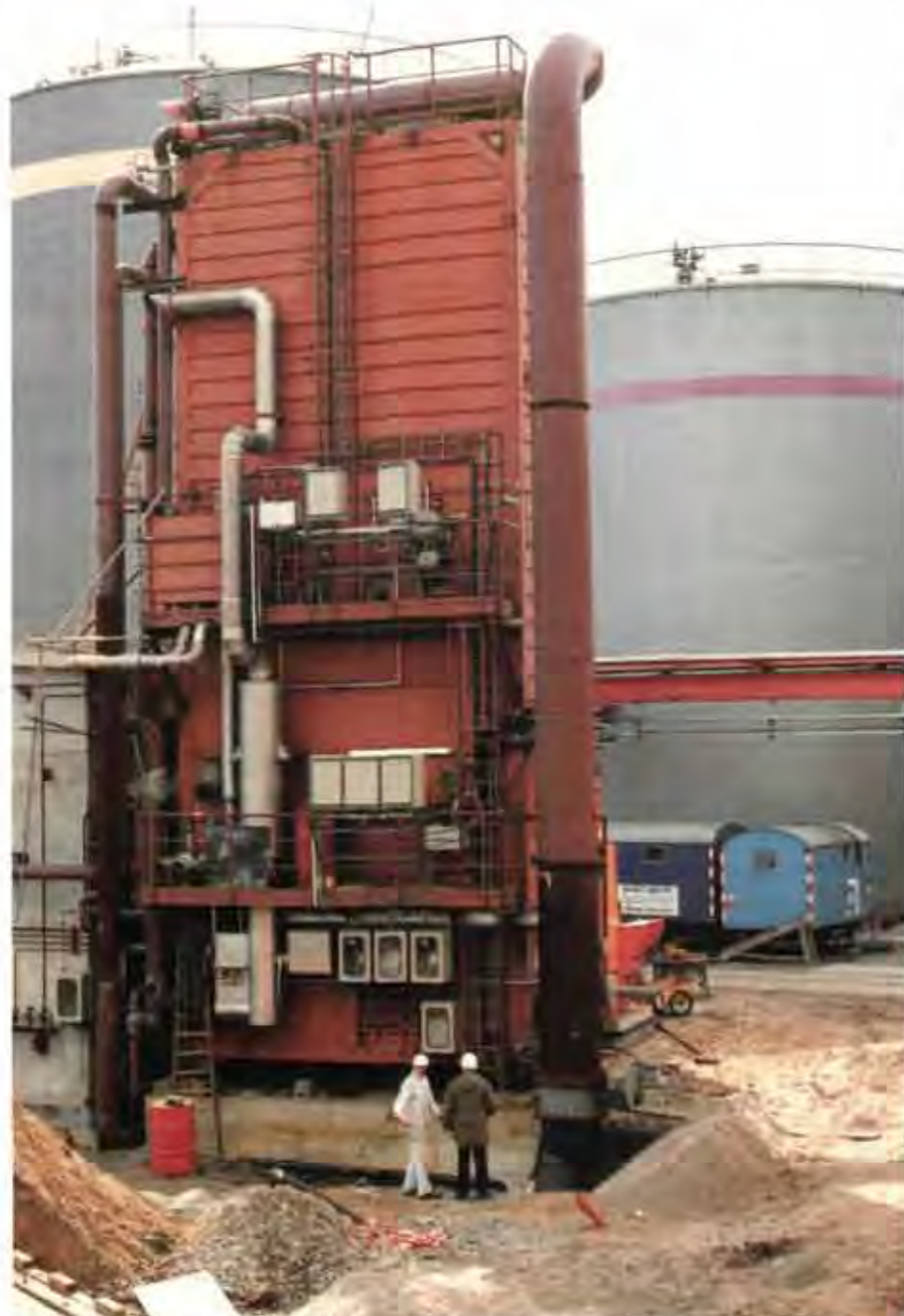
Produktion verflüssigt: Der Stromverbrauch für den neuen Stickstoff-Verflüssiger in Oberhausen entspricht dem Bedarf von 20000 Vier-Personen-Haushalten.
