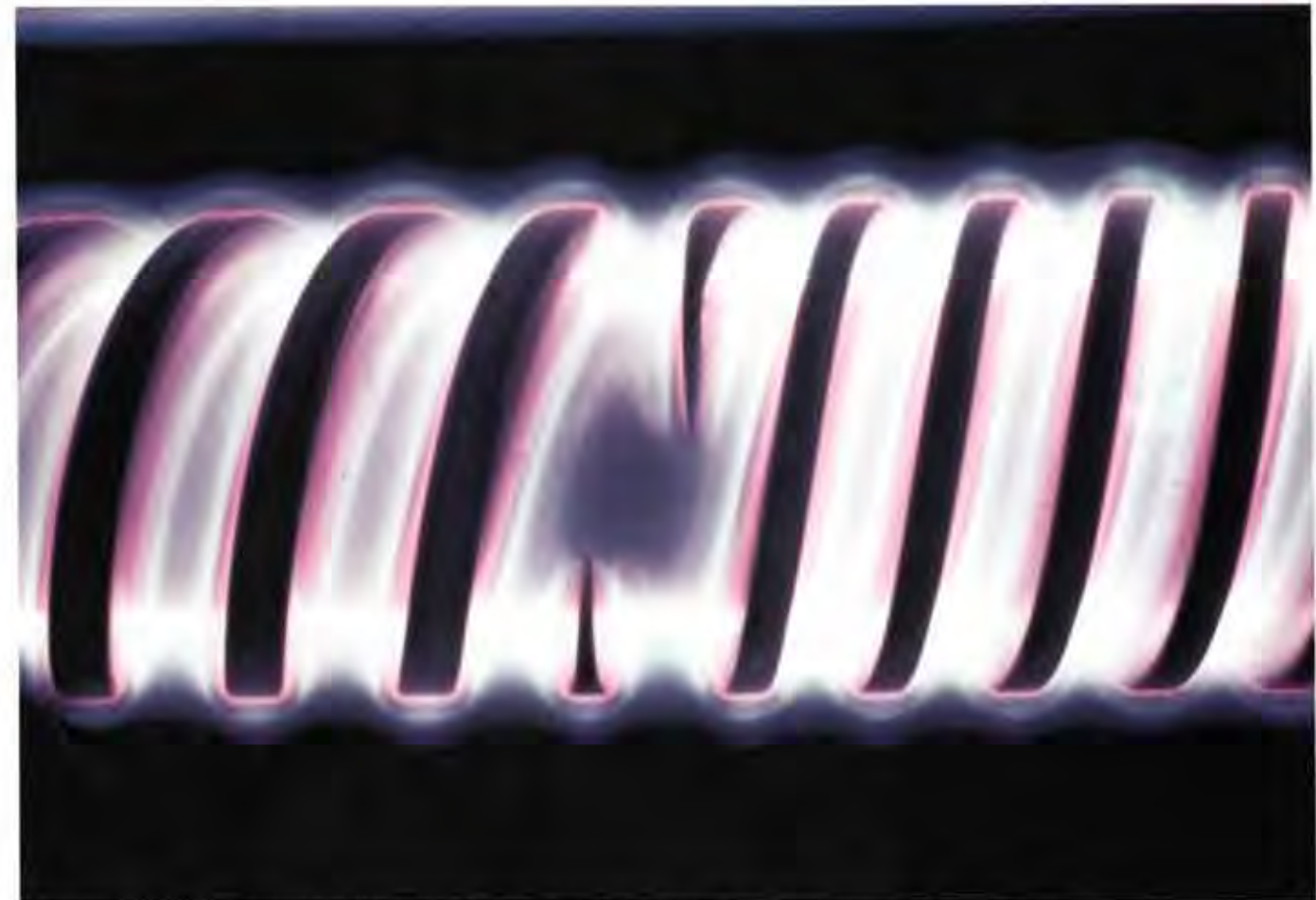
Extruderschnecken erhalten beim Nitrieren im Plasma hochfeste Oberflächen durch spezielle Gasgemische.
