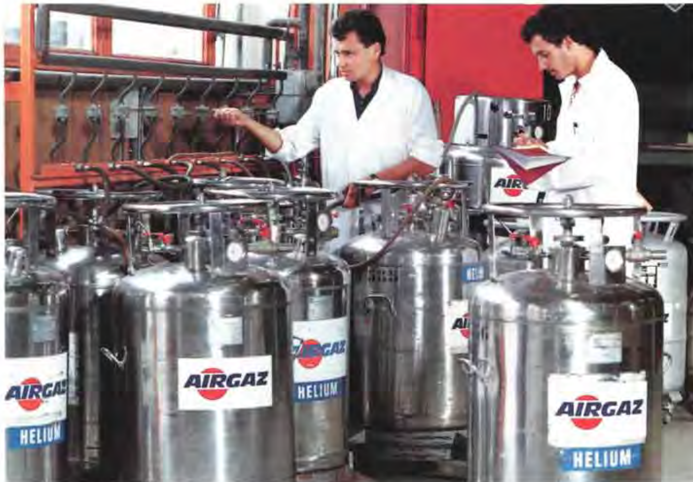
Superisolierte Behälter werden mit tiefkalten, verflüssigten Gasen gefüllt.
