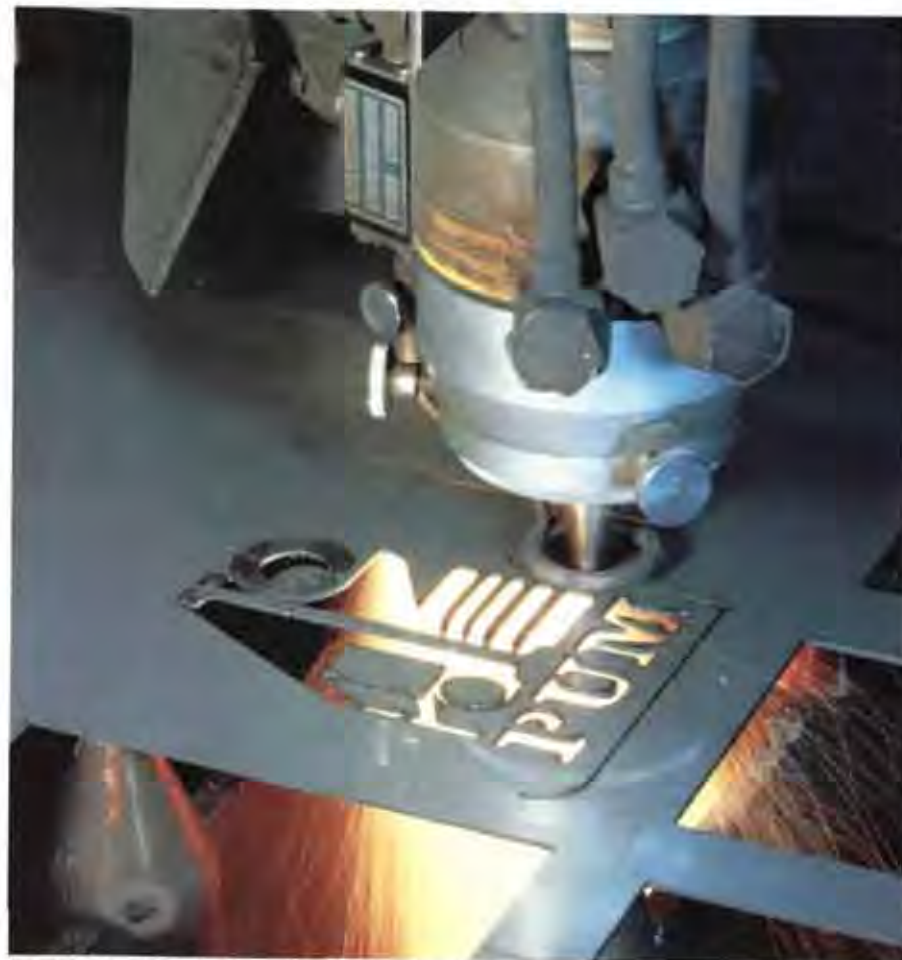
Laserschneiden in der größten Lohnschneiderei Frankreichs (PUM)
