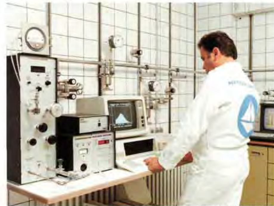
Qualitätssicherung: Die neue Modellanlage im Sondergaswerk Duisburg garantiert extrem genaue Analysen für reinste Gase zum Fertigen von Halbleitern.
