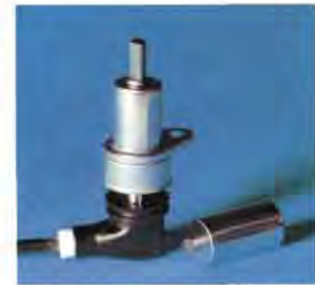
ABS-Sensor mit eingeschweißtem Magnetkern (Kondensator-Impulsschweißen, im Bild oben)
