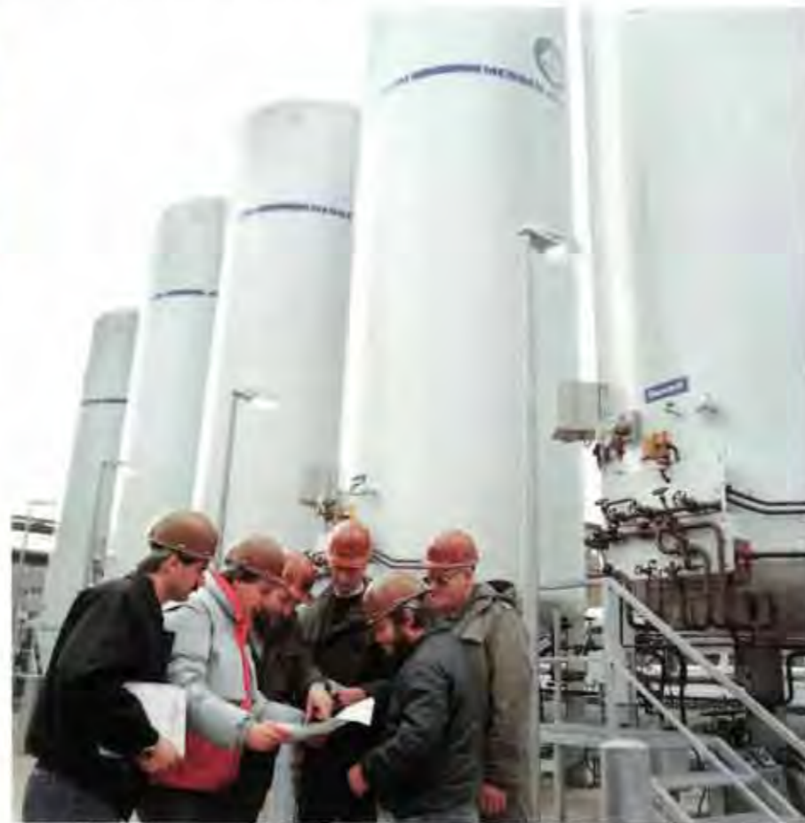
Bei der Krupp Koppers GmbH wird eine Pilotanlage für die Kohlevergasung erprobt. Dabei unverzichtbar sind Stickstoff als Inertgas und Sauerstoff für die Verbrennung.
