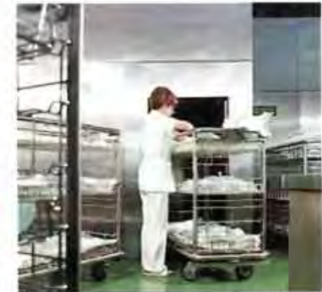
Wärmeempfindliche Krankenhausartikel werden mit Ethylenoxid kaltsterilisiert.
