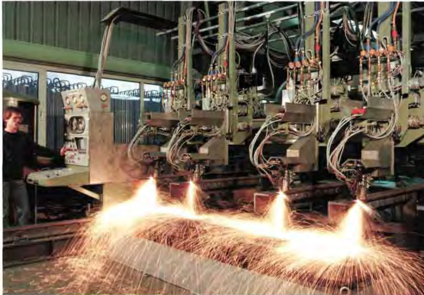
Träger-Schneiden auf der Werft: Transport-, Positionier- und Schneidvorgänge sind computergesteuert (System Oxytechnik).
