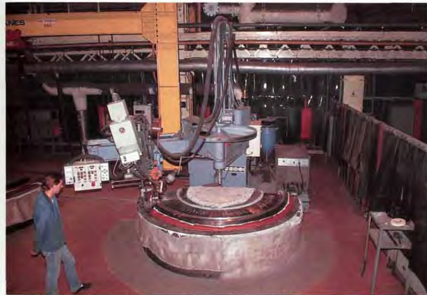
Ein englisches Unternehmen schweißt Turbinen unter dem Lichtbogen. Ersparnis: 30 % Schweißzeit
