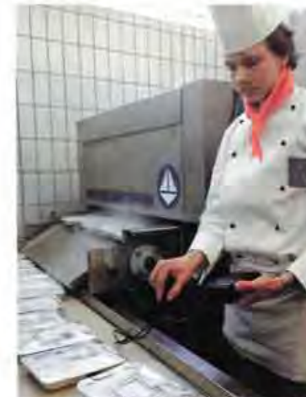
Geprüfte Qualität: Mit flüssigem Stickstoff oder Kohlensäure gefrostete Fertigerichte verlassen den Langtunnel mit der gewünschten Produkt-Kerntemperatur.
