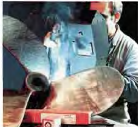
Auftragschweißen einer Schiffsschraube mit der dafür entwickelten Stabelektrode
