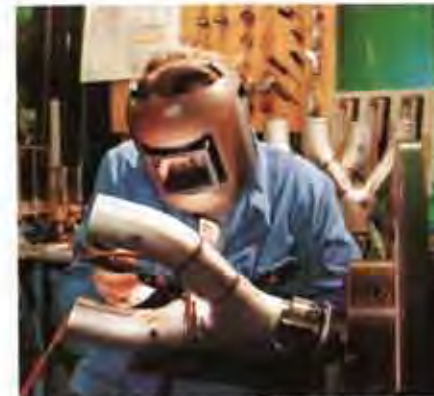
Wolfram-Inertgas-geschweißte Hosenrohre für das Lüftungssystem des Airbus'
