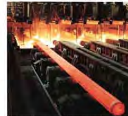
Automatisiert: das Brennschneiden von Rundblöcken in einer Strang-Gießanlage
