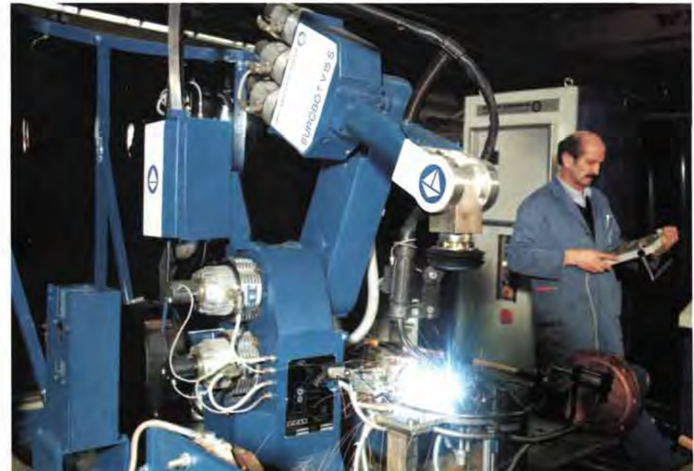
Zum Patent gemeldet: der neue Positionierer mit dem Schweiß- und Schneidroboter im Zentrum
