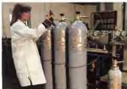
Innenwandvergütete Aluminium-Flaschen ermöglichen Prüfgase mit langjähriger Stabilitätsgarantie.
