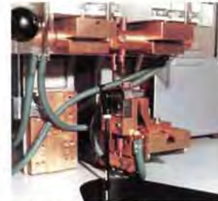
Punktschweißen am ABS-Sensor garantiert sichere Kabelanschlüsse mit der Induktorspule.
