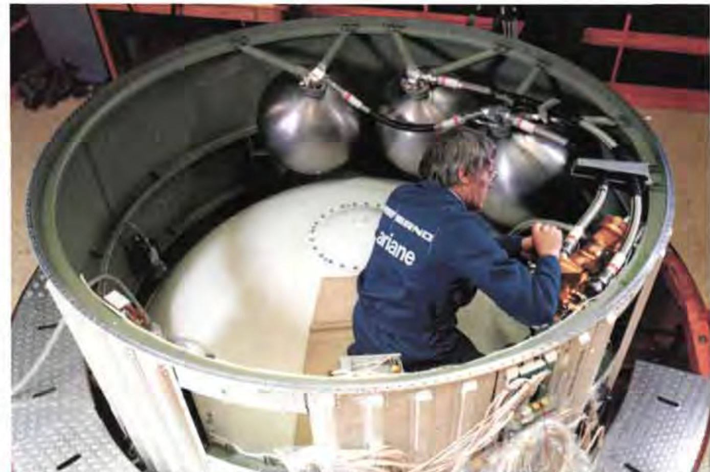
Sicherheit wird hier großgeschrieben: Die Tanks der Ariane-Raketen werden mit Stickstoff und Helium auf Druckfestigkeit und Dichtigkeit geprüft.
