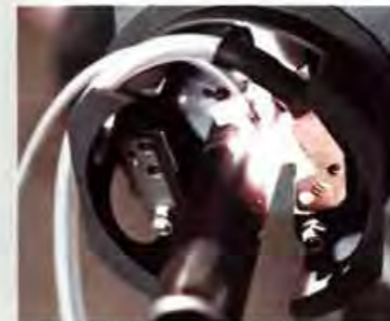
... für das Rohr-Stumpfschweißen im Wolfram-Inertgas-Verfahren.
