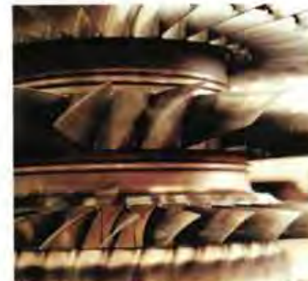
Das Elektronenstrahl-Schweißen ist konkurrenzlos beim Einschweißen der Schaukeln in den Leitkranz.
