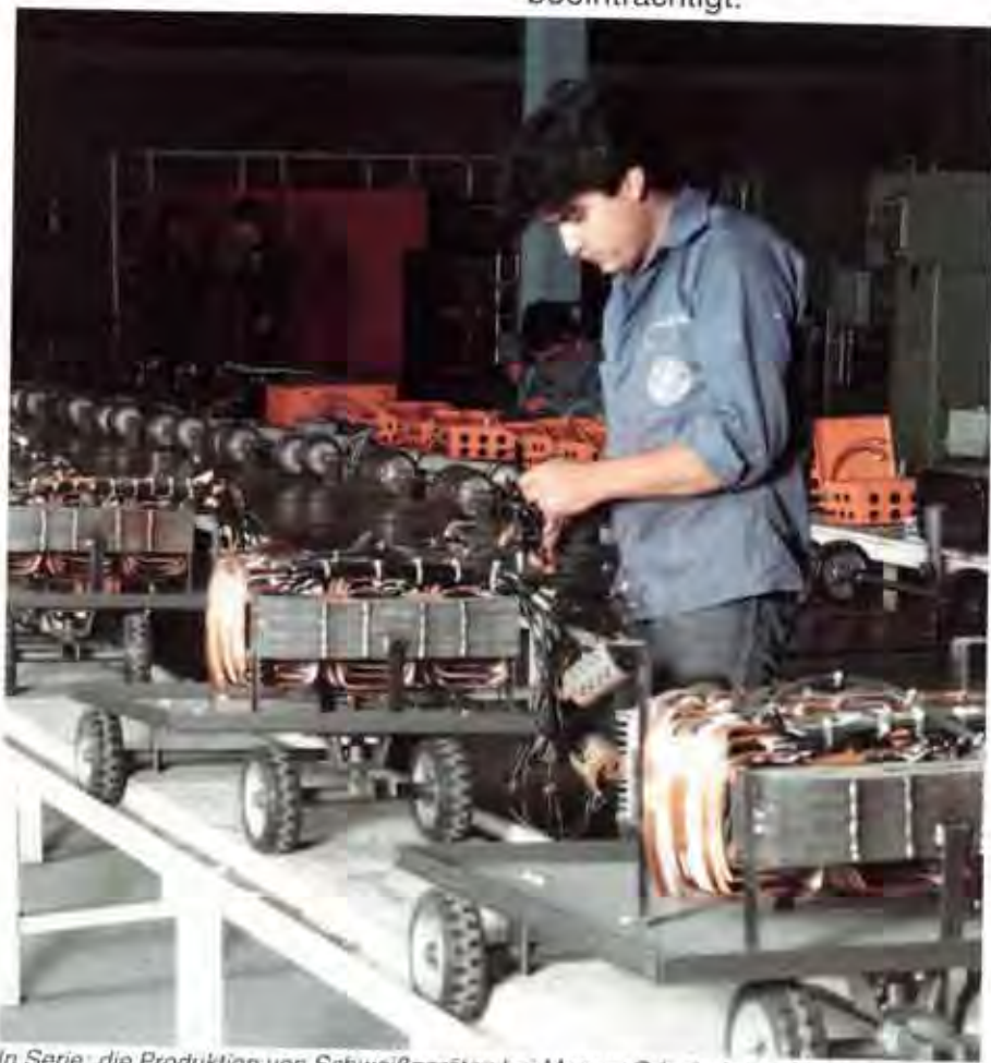
In Serie: die Produktion von Schweißgeräten bei Messer Griesheim de Mexico
