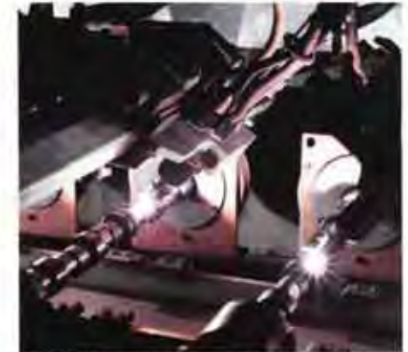
Durch Umschmelzhärten unter dem WIG-Lichtbogen wird die Güte der Kurbelwellen verbessert.
