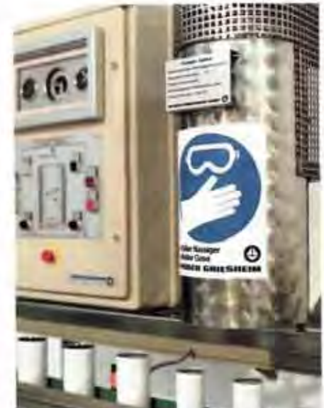
Kleiner Tropfen – große Wirkung: Um Getränkedosen prall, stabil und stapelfähig zu machen, genügt bereits ein Tropfen flüssiger Stickstoff aus dem Dosiergerät. Der eingespritzte Tropfen verdampft und erzeugt den nötigen Innendruck.
